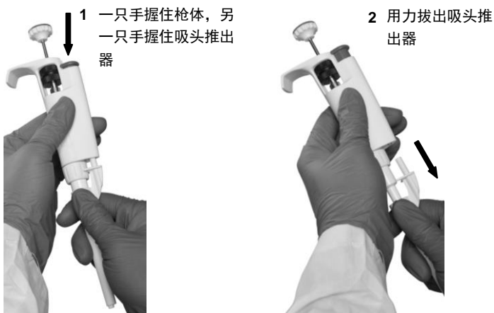
图 4. 拆卸吸头推出器
